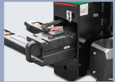
Batería fácilmente reemplazable
